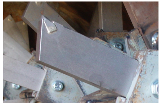
Option: Messer mit Hartmetalleinlage
